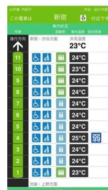
Рисунок 17. Приложение JR East, показывающее ситуацию в каждом поезде в режиме реального времени: уровень загруженности, температура и наличие условий для пассажиров ограниченной подвижностью
