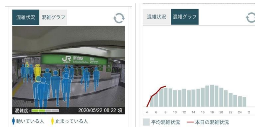
Рисунок 15. Пример компании JR East с отражением реальной ситуации на станции (рис. слева) и уровня загруженности на станции на основе данных, полученных в режиме реального времени (красная линия на рис. справа), а также на основе статистических данных за последнюю неделю
